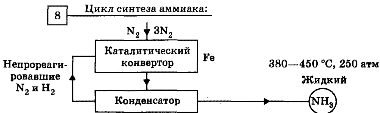
Рис. 20.2. Стадии промышленного процесса получения аммиака
